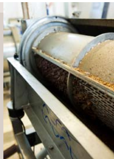
Обработка оливок в измельчителе Альфа Лаваль на маслозаводе Mondeggi.
